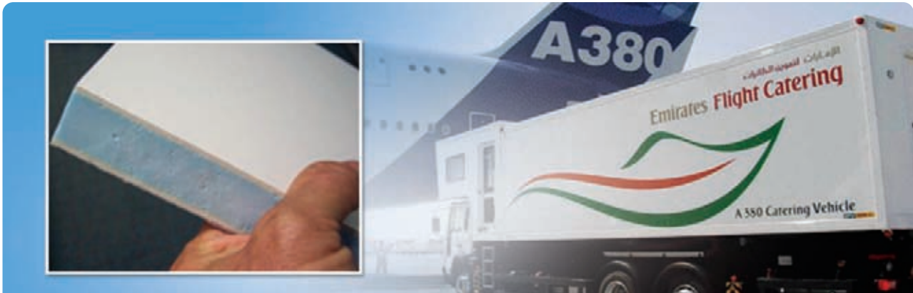
“BIG BAO” ตู้คอนเทนเนอร์น้ำหนักเบาด้วยผนังแซนวิช
